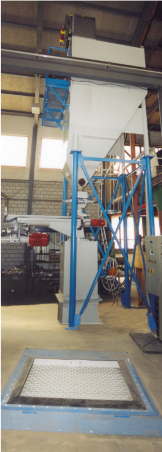
Doppelkammersilo mit Bühne und Aufsatzfilter Inhalt 18 m 3
